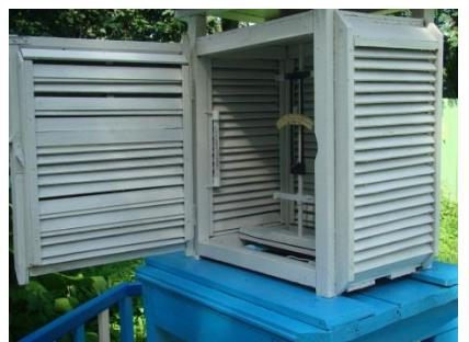
Будка состоит из четырех жалюзийных стенок, пола, потолка и крыши, укрепленных на деревянном остове. Стенки представляют собой двойной ряд тонких деревянных планок—жалюзи, наклоненных внутрь и наружу будки под углом
